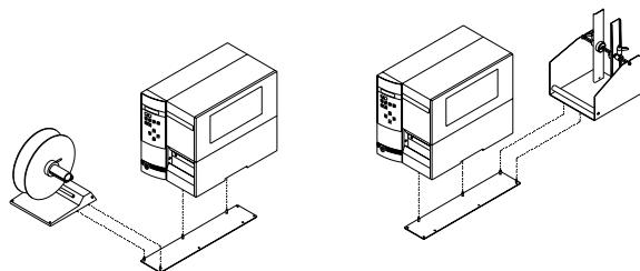
Die Verbindung der PA50 A zum Drucker ist so zu wählen, dass der rechte Gerätedeckel mit der rechten Außenwand der Abwickelvorrichtung bündig ist.
