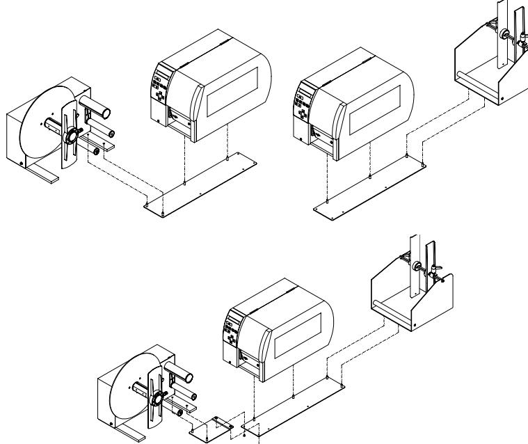
Die Verbindung der PA50 A zum Drucker ist so zu wählen, dass der rechte Gerätedeckel mit der rechten Außenwand der Abwickelvorrichtung bündig ist.
