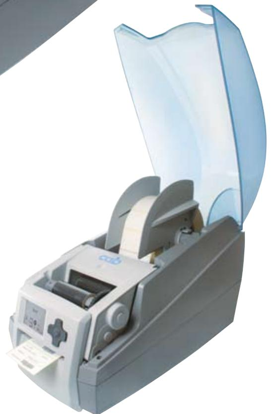
MACH4 wird in zwei Ausführungen geliefert. Serienmäßig mit Spendefunktion. Dabei wird das Trägerband hinter dem Bedienfeld nach unten geführt. Der zweite Gerätetyp ist mit einem Schneidemesser ausgerüstet. Dieses ist im Bedienfeld integriert und schneidet Materialien bis 200 g/m<sup>2</sup>.
