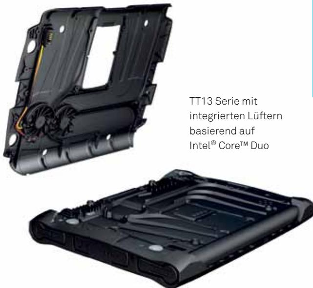
TT13 Serie mit integrierten Lüftern basierend auf Intel® Core™ Duo
