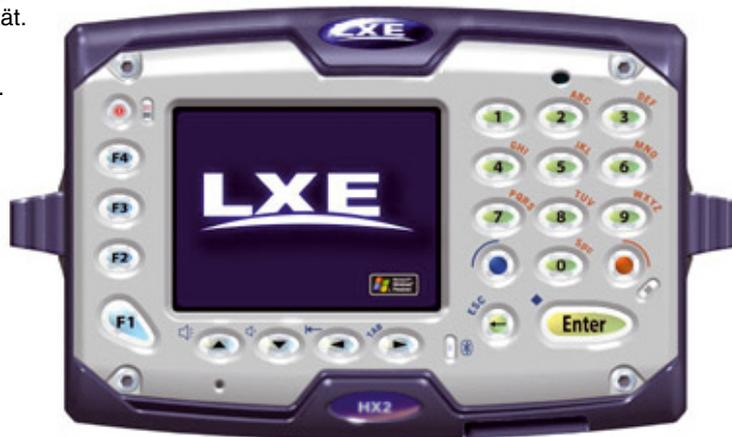
Das Tastaturdesign mit unterschiedlich großen Tasten ermöglicht „blinde“ Navigation und Eingabe.
