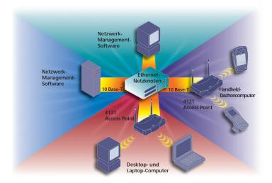
Spectrum24 High Rate Access Points kommunizieren mit einer beliebigen Anzahl an Geräten, die mit Spectrum24 Client-Adaptern ausgestattet sind, einschließlich Symbol Taschencomputern.
